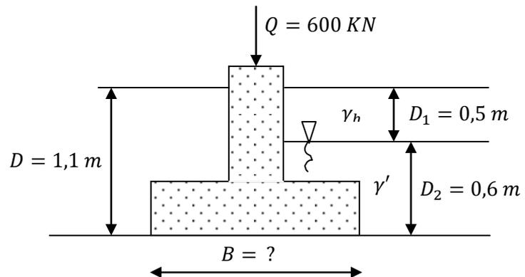
$\rightarrow$  Il est demandé de calculer la largeur nécessaire de la fondation si  $F_s = 4,2$
