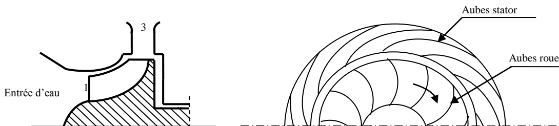
Fig.2. Coupe d'une pompe centrifuge
